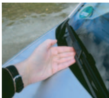
Die Scheibenwischer lassen sich in Ruhestel- lung nicht abklappen, das ist unpraktisch bei der Fahrzeugpflege.
