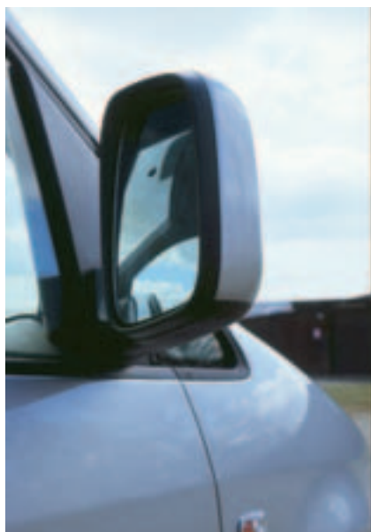
Dem Außenspiegel rechts fehlt ein Weitwinkel- feld – beim verblechten Kastenwagen unange- nehm.
