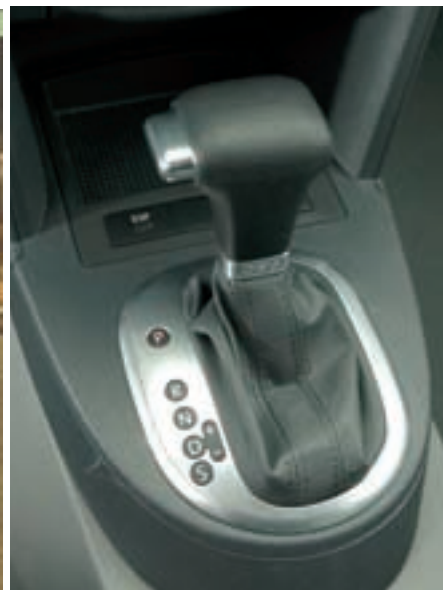
VW Caddy: äußerlich unverändert, durch DSG-Getriebe aber erheblich aufgewertet. Wählhebel und Kulisse wie bei einem Automatikgetriebe, Funktion jedoch auf besserem Niveau
