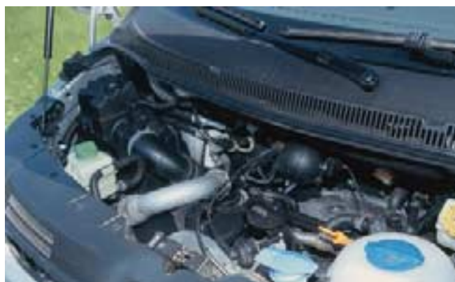
Der Fünfzylinder-Turbodiesel mit 400 Nm Drehmoment entwickelt Bärenkräfte.
