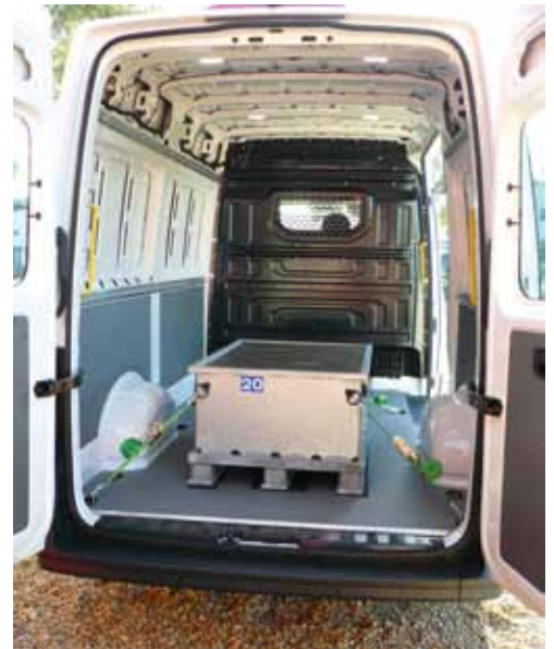
Dank Frontantrieb sinkt der Ladeboden, daher ist das Volumen gewachsen und der Zugang einfacher.
