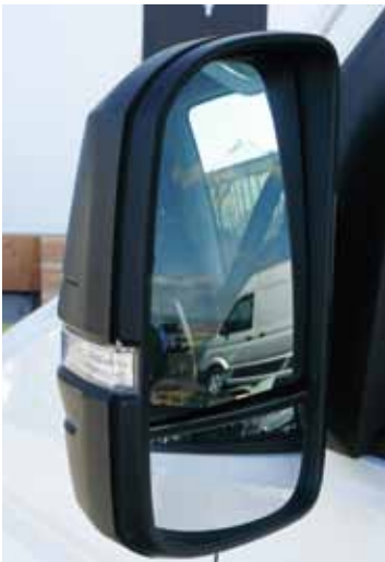
Gut, aber nicht gut genug: Die Weitwinkelgläser der großen Außenspiegel sind nicht verstellbar.
