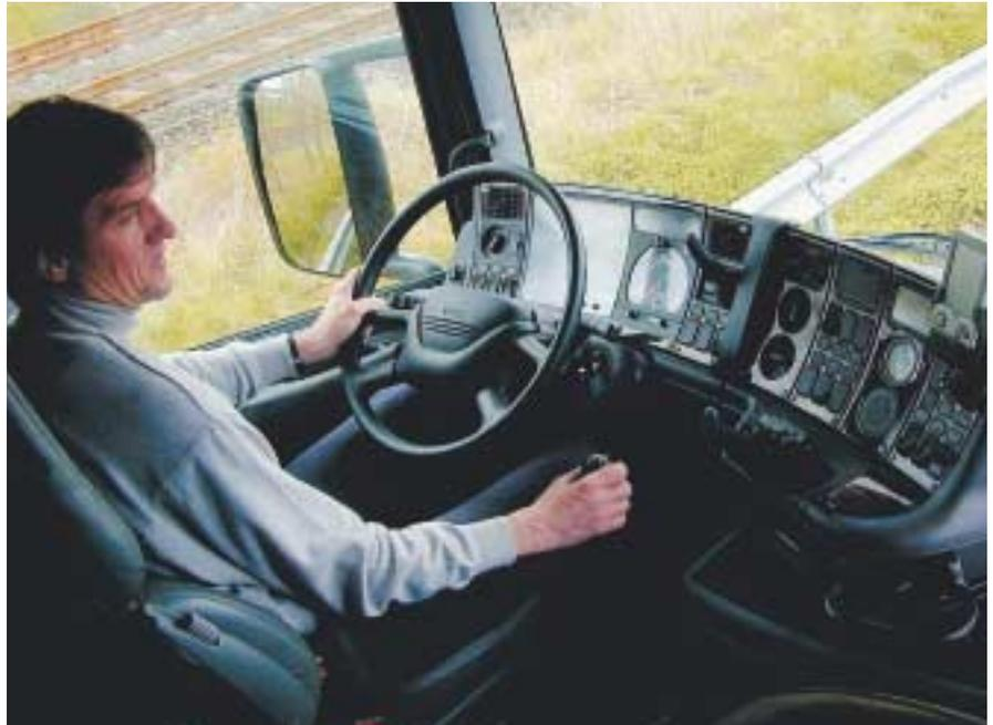
ten und einer um acht Prozent ansteigenden Serpentinestrecke von etwa 4 km Länge. Hier reichten, bis auf wenige Ausnahmen, der 11. und 12. Gang des Scania-12-Gang-Getriebes GRS 900 aus. Das war besonders angenehm, denn der Gangwechsel vom 6. Gang groß in den 6. Gang klein erfolgt in der Splitgruppe per Kippschaltevorwahl mit Kupplungs-betätigung.
