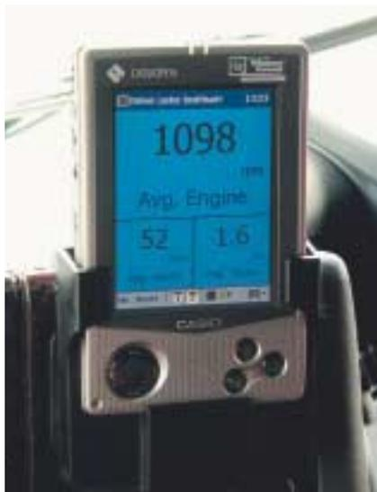
**Scan Telematics:** Der mobile Mini-Computer des Scania Fuhrpark-Analyse-Systems ist Datenträger und Multifunktionsanzeige in einem.
