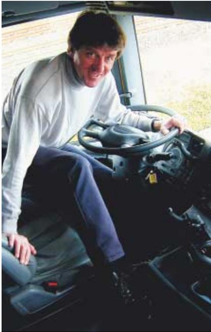
**Umständlich:** Der Aufstieg auf den Motortunnel ist nur nach Rückstellen des Sitzes, Umlegen des Schalhebels und Hochklappen des Lenkrades möglich.
