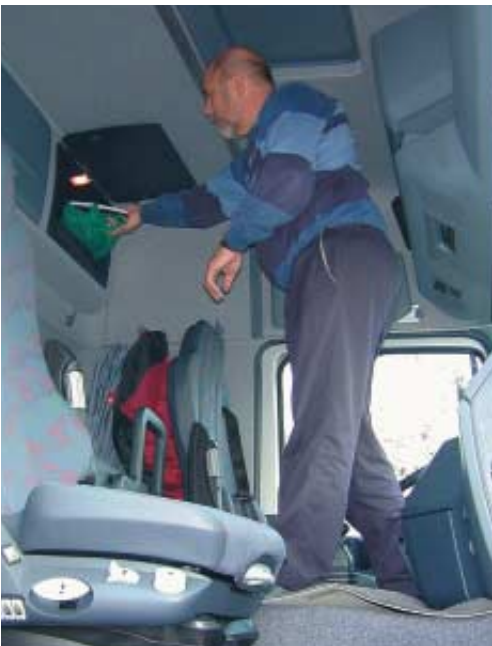
Für ein bequemes Ein- und Aussteigen lassen sich der Sitzschnellabsenker und das Lenkrad einfach nach oben klappen. (oben) Die Kabine zeichnet sich durch wohnliches Interieur, jede Menge Staufächer und Ablagemöglichkeiten sowie eine gute Stehhöhe aus. (unten)
