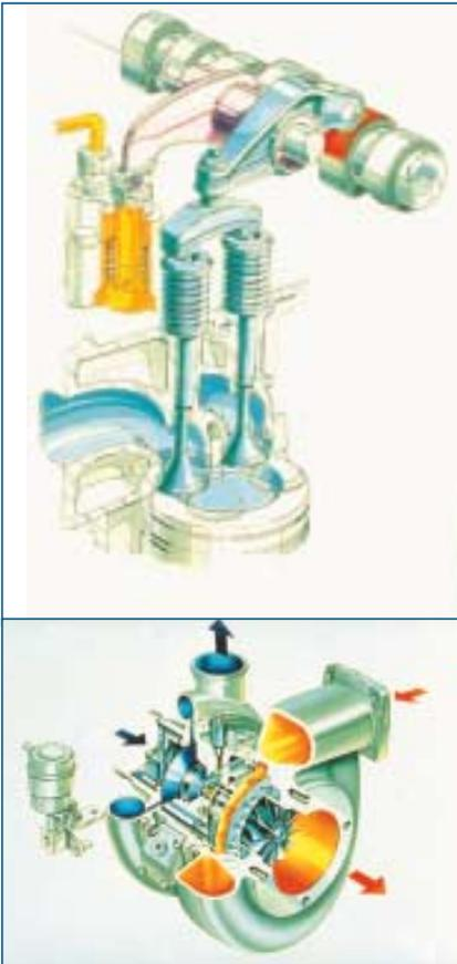
Die EDC-geregelte Iveco Turbo-Brake ist eine leistungsstarke Kombination von Dekompressions-Motorbremse und Aufladung durch den Abgasturbolader mit variabler Geometrie.
