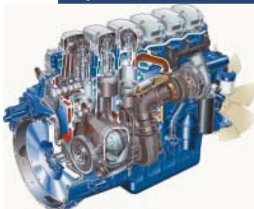
Der Scania Motor DT12 02 470 mit Turbocompound-Technologie und neuartigem HPI-Direkteinspritz-System
