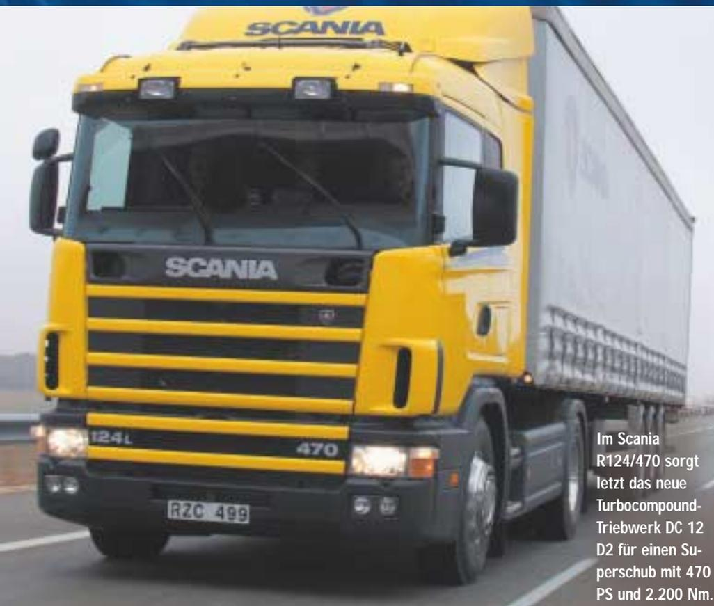
Im Scania R124/470 sorgt jetzt das neue Turbocompound-Triebwerk DC 12 D2 für einen Superschub mit 470 PS und 2.200 Nm.
