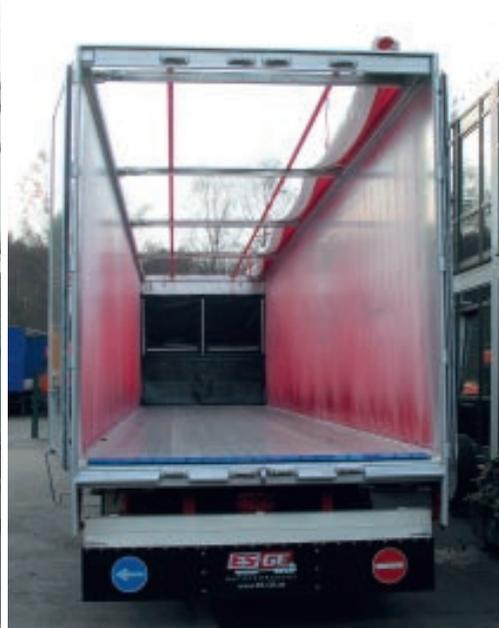
**Aufgemacht: Der Serrus-Schubboden verfügt über 92,5 m³ Ladevolumen.**
