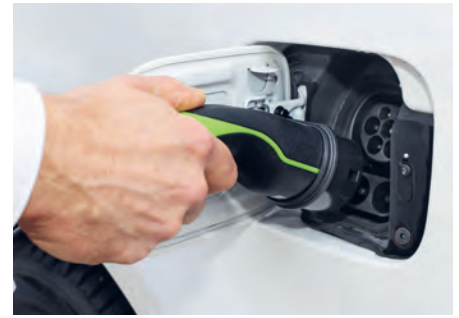
Strom wird dem E-Caddy per Typ-2-Stecker eingeflößt, er verträgt auch Schnellladungen bis 50 kW.
