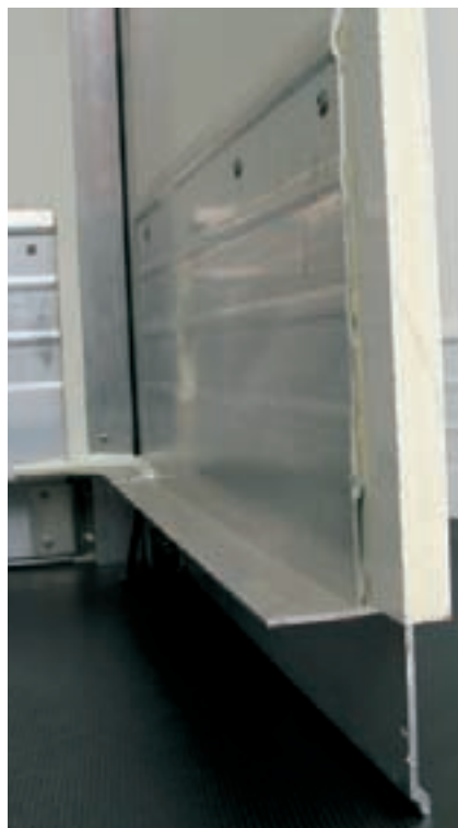
... Seitenwandpaneele mit Doppelstockausstattung (Foto Mitte); Schnittmodell: Sandwich light mit Palettenstoßkante und Rahmenprofil (Foto re.)
