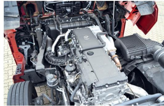
Effizientes Triebwerk: der 449-PS-Motor des Actros
