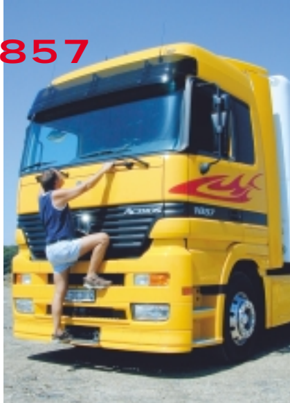
Die Kletterpartie zur Scheibenreinigung ist über rutschhemmende Tritte und großdimensionierte Haltegriffe abgesichert.
