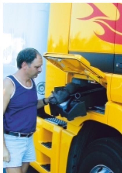
Für Werkzeug und andere Gegenstände gibt es nach innen geruchsdichte und nur von außen zugängliche Staufächer.
