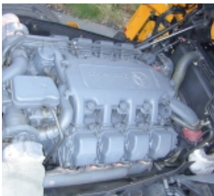
Nach Kippen der Megaspaces-Kabine zeigt sich das mächtige, 570 PS starke V8-Triebwerk.
