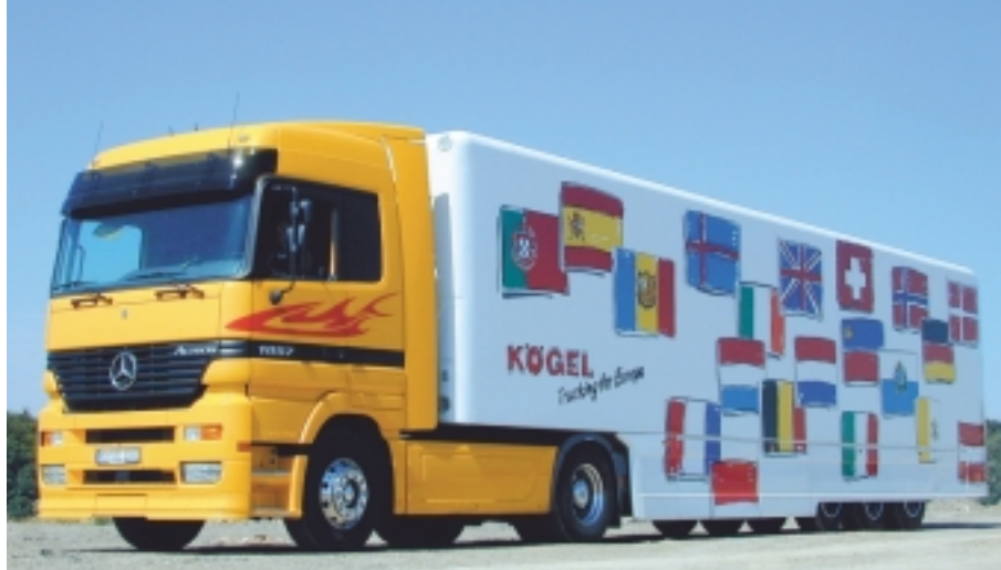
Spoiler-Set und Seitenverkleidungen sorgten sowohl beim Actros 1857 als auch beim Kögel-Auflieger für eine günstige Aerodynamik.
