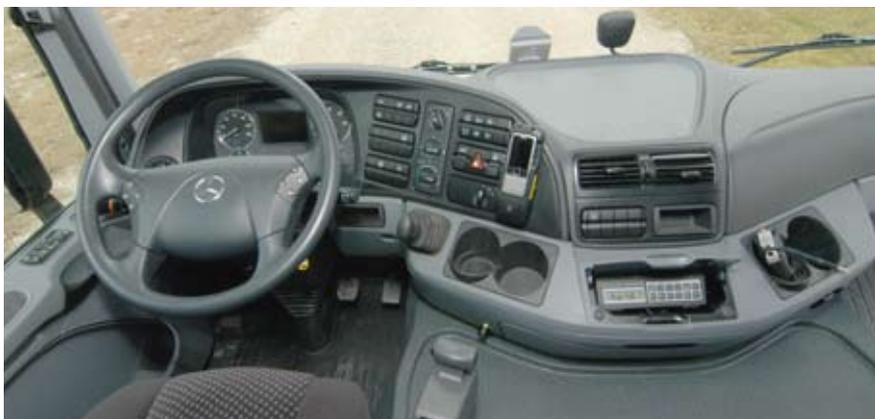
mit praxisgerechter Ausstattung, alles Nötige geht bestens zur Hand, nur langbeinige Fahrer wünschen sich die Sitzschienen ein wenig länger. Mit pneumatisch verstellbarem Lenkrad, Bordcomputer und Schaltkonsole am Sitz zieht der Kipperfahrer mit den Truckern des Fernverkehrs gleich. Elektrisch verstellbare Spiegel und die Fensterheber sitzen auf
