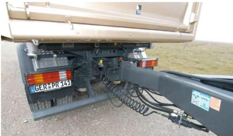
**Nicht optimal gelöst: Die Anhängeranschlüsse für Luft, Strom, ABS und die Hydraulik sind zu eng montiert.**
