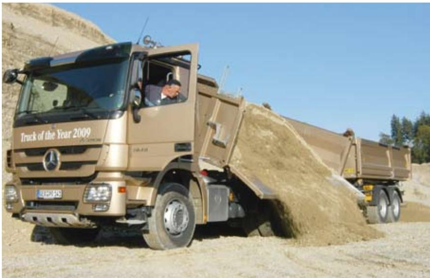
**Die Bordmatik vereinfacht das Abladen und erhöht die Umlaufgeschwindigkeit.**
