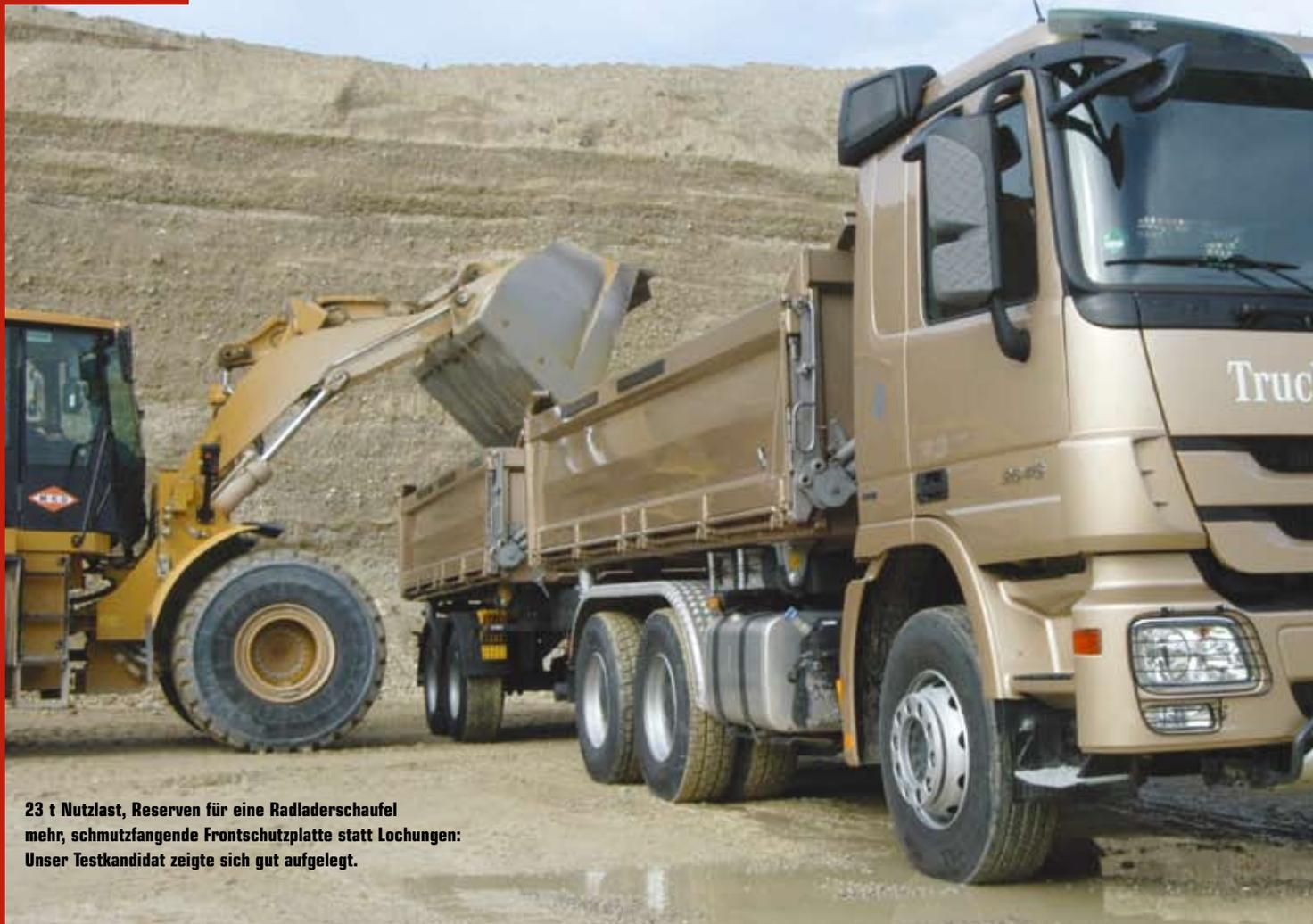
23 t Nutzlast, Reserven für eine Radladerschaufel mehr, schmutzfangende Frontschutzplatte statt Lochungen: Unser Testkandidat zeigte sich gut aufgelegt.
