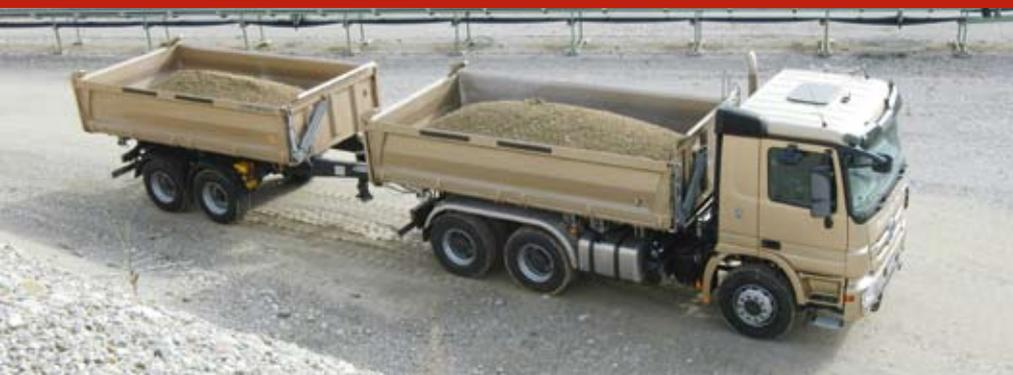
spielt der schwere Mercedes-Dreiaxler nicht den Maximalisten, im Zugbetrieb mit dem Zentralachsenanhänger darf er 23 t laden – ein vergleichbarer Sattelzug packt deren 26 und mehr. Die beiden Antriebsachsen, gut für bis zu 13 t Achslast, federn aufwändig mit acht Luftbälgen, die leer wie beladen für eine konstante Ladehöhe sorgen. Damit ist der Actros für den Winterdienst gerüstet – zusammen mit einer Kommunalhydraulik ist er auch für Straßenbauämter interessant.
