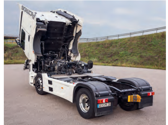
Die gekippte Fahrerkabine gibt den Blick auf die neueste Motorentechnik frei.
