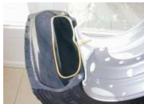
Top-Innovation: Der Super-Single für die Antriebsachse besitzt einen Notlaufreifen, das spart das Reserverad.
