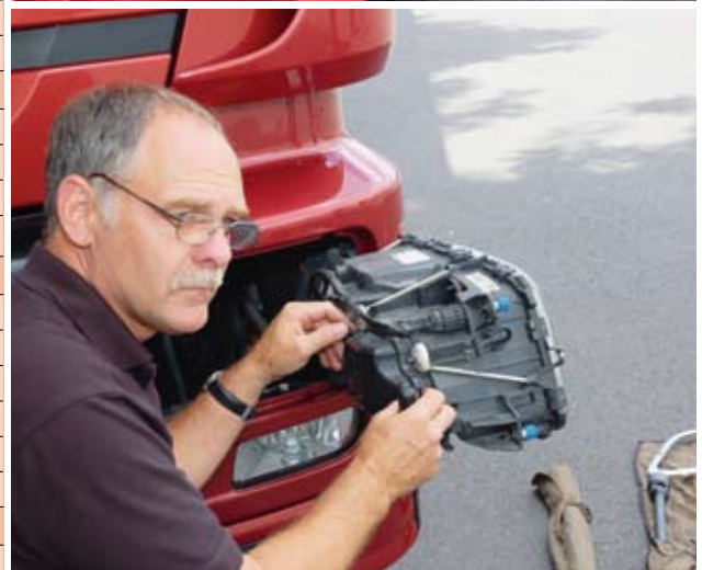
Schnelle Innen- reinigung mit Druckluft (oben); einfacher Birnenwechsel
