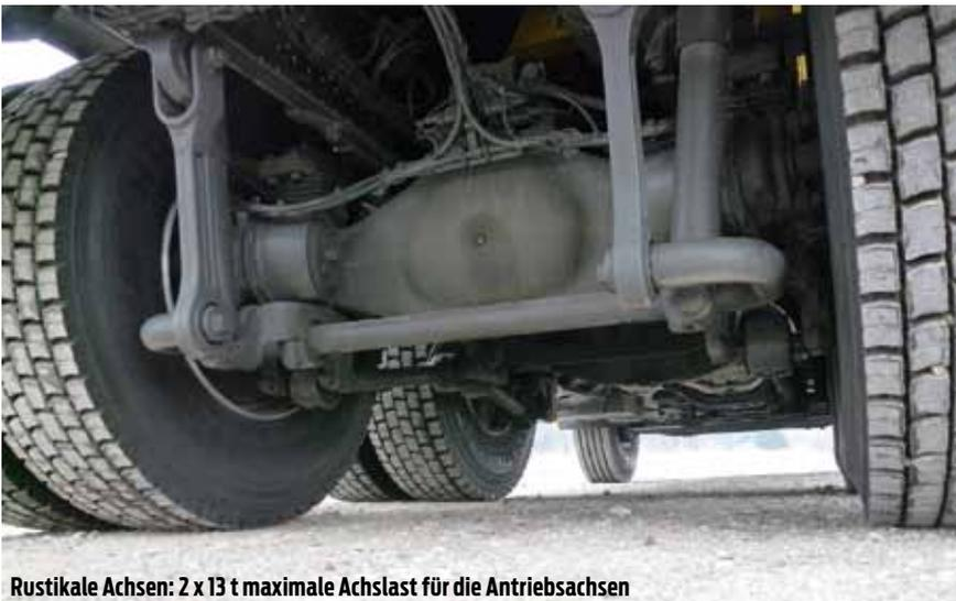
Rustikale Achsen: 2 x 13 t maximale Achslast für die Antriebsachsen
