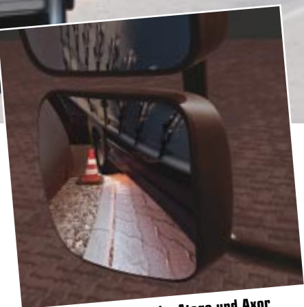
Auf Wunsch gibt es beim Atego und Axor Arbeitsscheinwerfer im Hinterachsbereich als Rangierhilfe bei Nacht.
