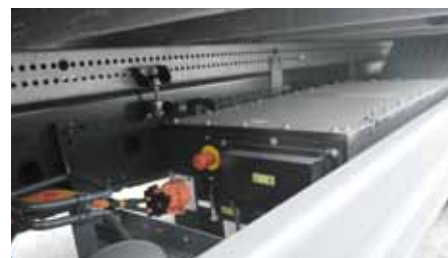
Sicher verwahrt hinter dem Unterfahrschutz: Li-Ionen-Batterie und Leistungselektronik
