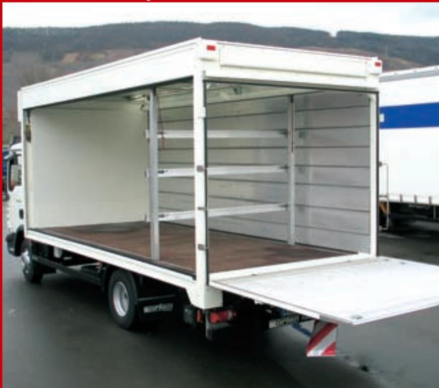
Hut hoch: Hubhöhe 400 Millimeter
