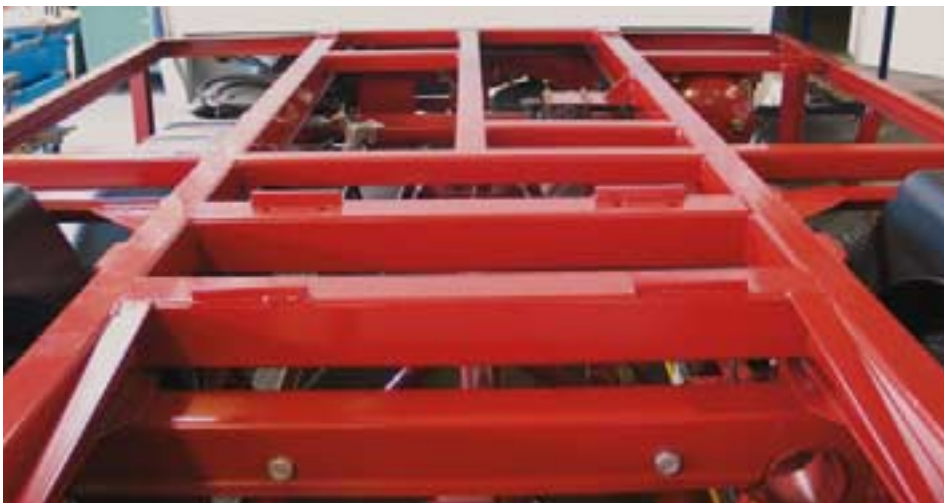
Auslegung vorgeschrieben: Hilfsrahmen für die Sattelkupplung
