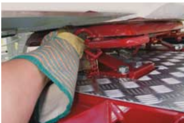
Luftpresser am Iveco-Motor (Foto oben); traditionell schwer erreichbar: Verschluss der Sattelkupplung (Foto unten)
