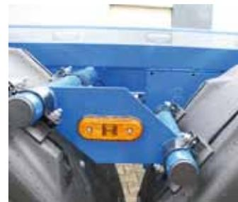
Kotflügel-Aufhängung in Massivbauweise
