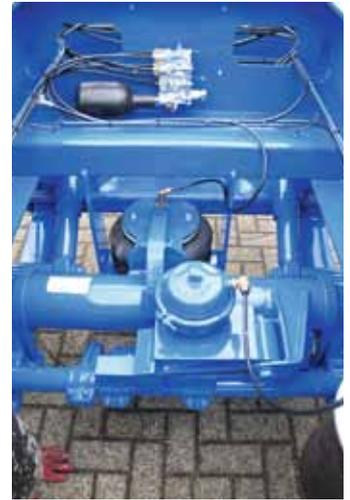
Liftbare Lenkachse mit Dämpfer am Liftachsventil
