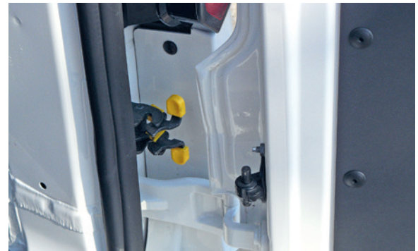
Die Aufsteller der Hecktüren verdrücken sich beim Testwagen ins Türblatt.
