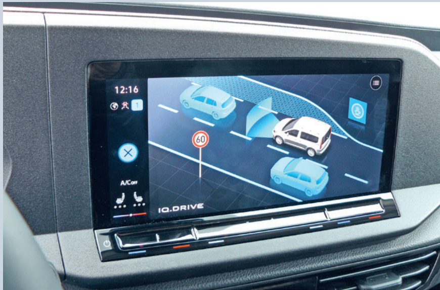
Augenfällige Bedienung der Assistenzsysteme: Fingertipp auf die Details der Szene zum Ein- und Ausschalten.
