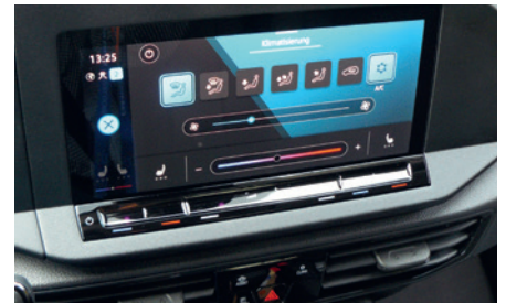
Digital-Cockpit: virtuelle Rundinstrumente, dazwischen eine frei belegbare Fläche, hier als Bordrechner. Alternativ große Navi-Anzeige und kleine Instrumente (Bild links). Klimaregelung im Monitor: virtuelle Schieberegler und Tiptasten, vorher die Taste „Klima“ erwischen.
