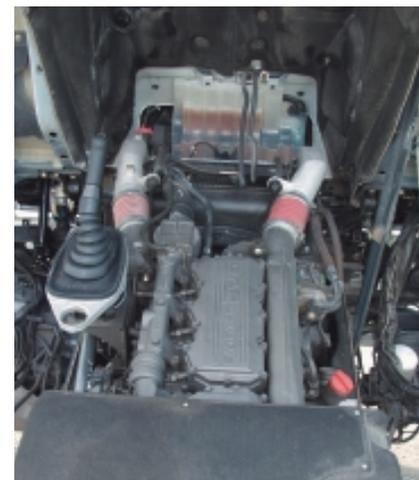
Der 9,2-l-Hightech-Diesel von DAF Trucks mit UPEC-Direkteinspritzung.
