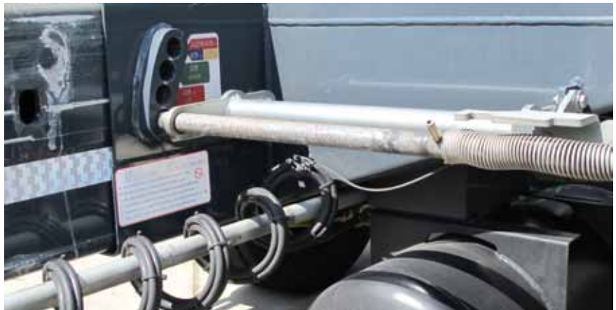
Schablone für die Ausschublängen in vier Einstellhöhen
