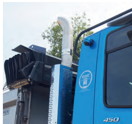
CornerEye (von Orlaco) als Abbiegeassistent: Die lichtempfindliche Kamera an der B-Säule bietet ein großes Sichtfeld in den sonst toten Winkel.
