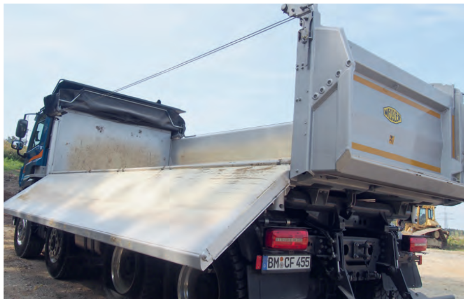
Schnelles Abkippen, Ladungssicherung leicht gemacht: Bordmatik linksseitig, die elektrische Schiebeplane spart Zeit und Aufwand.
