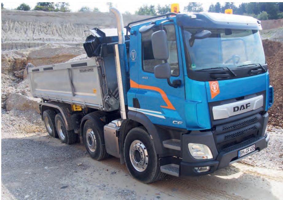
CornerEye (von Orlaco) als Abbiegeassistent: Die lichtempfindliche Kamera an der B-Säule bietet ein großes Sichtfeld in den sonst toten Winkel.
