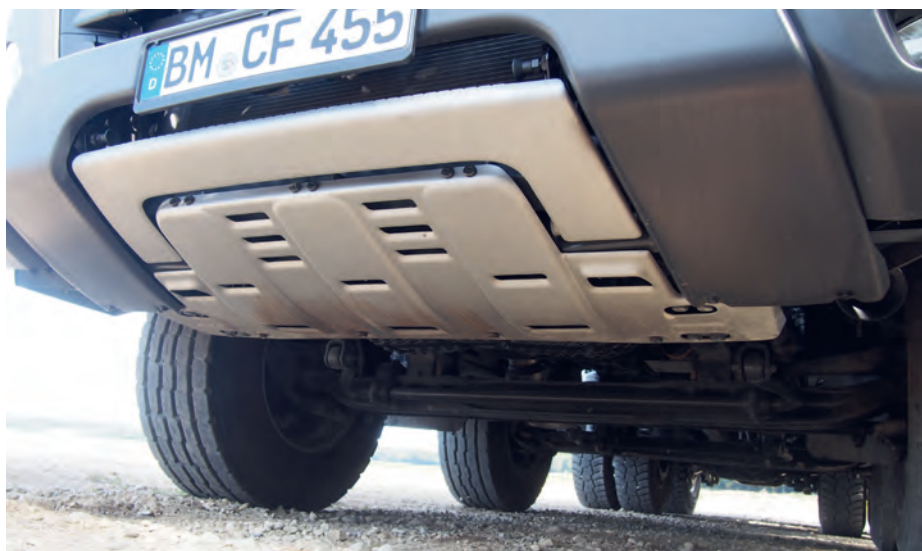
Keine Angst vor Bodenkontakt: Die Metallplatte bewahrt Kühler und Ölwanne vor Aufsitzchäden.
