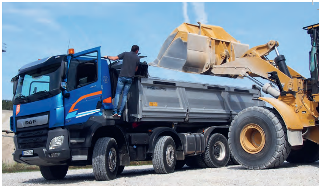
Allrounder im Einsatz: Bis zu 37 Tonnen Gesamtgewicht sind technisch möglich.
