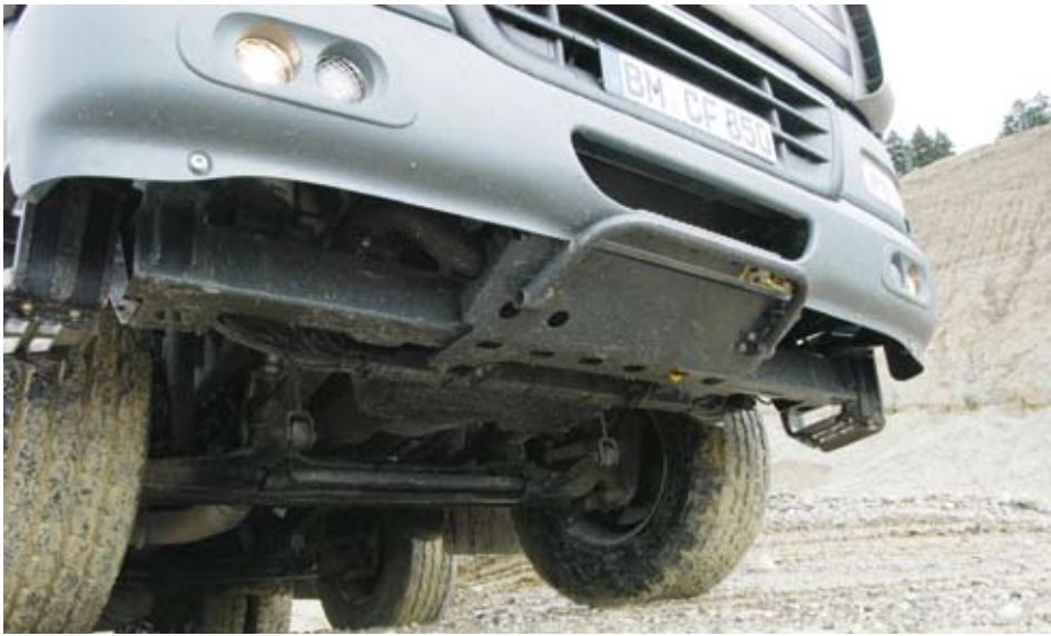
Die langen Parabelfedern sorgen für guten Federungskomfort, die Supersingle-Reifen für geringeres Bodendruck und sanftes Abrollen (Bild oben)
