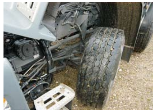
Die langen Parabelfedern sorgen für guten Federungskomfort, die Supersingle-Reifen für geringeres Bodendruck und sanftes Abrollen (Bild oben)
