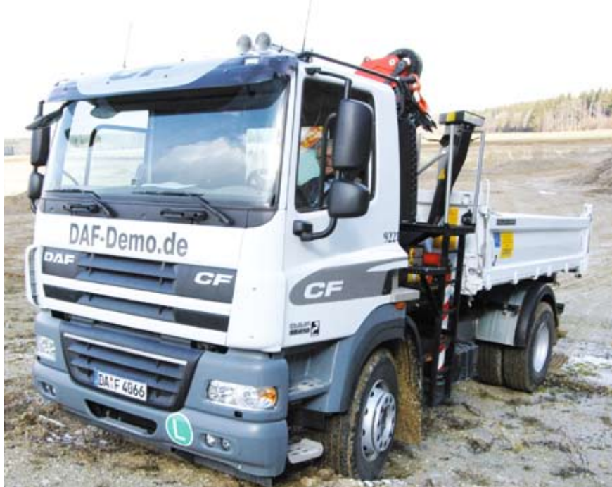
Gut geschützt im Gelände mit Stahlstoßstange und Kühlerschutzwanne
