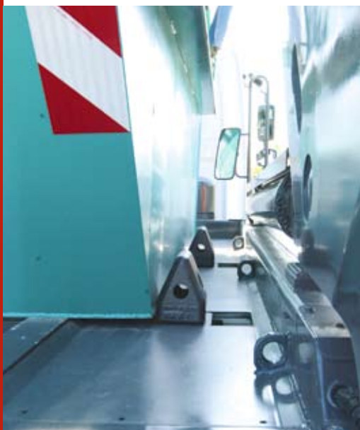
Die seitlichen Anschläge werden hydraulisch arretiert.
