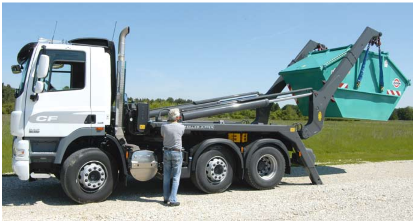
Mit ausgefahrenen Teleskoparmen reduziert sich die Hublast auf rund 10 Tonnen.
