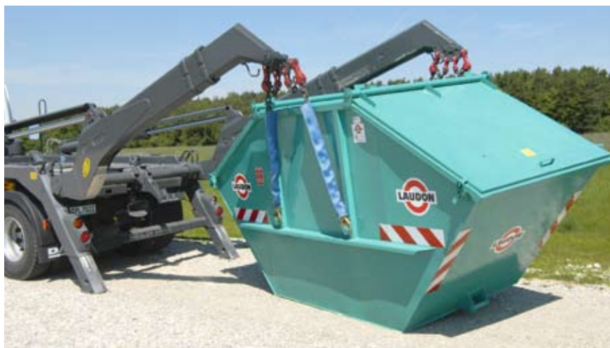
Behälter verrücken möglich – mit der einzelnen Ansteuerung der Teleskoparme
