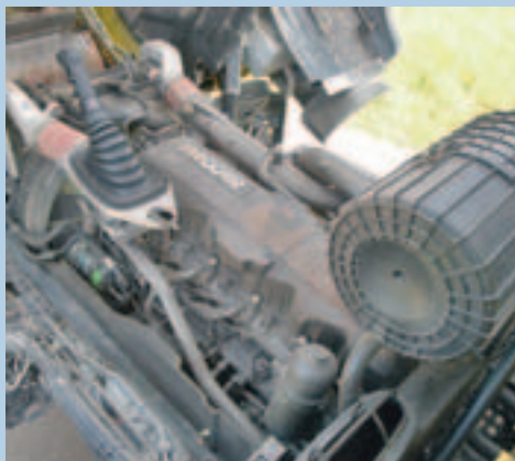
Starkes Herz: MX-Sechszylinder mit 12,9 l und 460 PS
