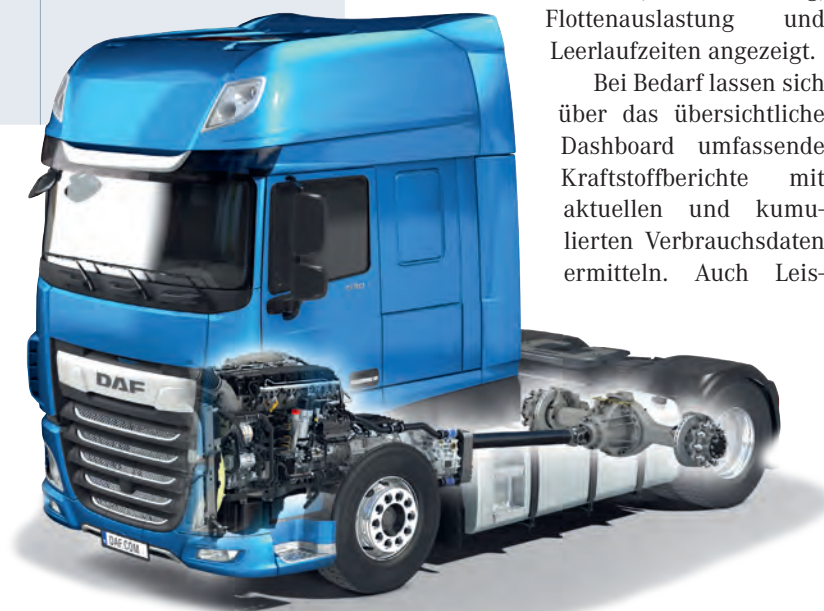
Blick in den Antriebstrang beim DAF XF Super Space Cab
