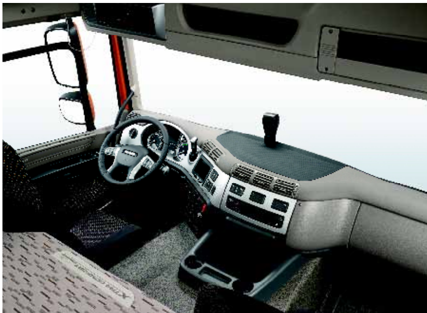
Wohlgeordneter LF-Arbeitsplatz – die Motorbremstaste im Lenkrad ist allerdings deplatziert.
