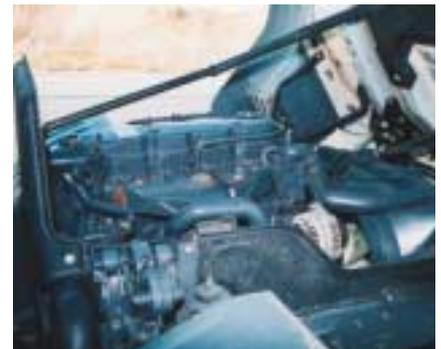
**Kompakter Vortrieb: Der 4-Zylinder-Common-Rail-Diesel mit 3,9-l-Hubraum zeigt eine überaus elastische Charakteristik.**
