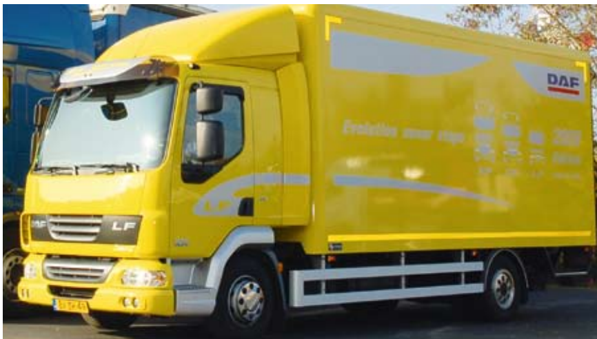
Der DAF LF 45.210 mit 4,30 m Radstand zeigte sich beim Test als wendiges Verteilerfahrzeug.
