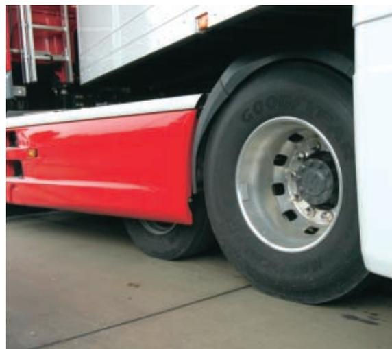
keting-Experten das Konzept nennen – die zusätzliche starre Achse erhöht die Tragfähigkeit der Hinterachse bei Bedarf um weitere 4,4 Tonnen. Die kleinen Stützräder verschaffen dem Spediteur mehr Spielraum bei Transporten von Secontainern oder sonstigen Einsätzen, wo das Ladungsgewicht überproportional im
