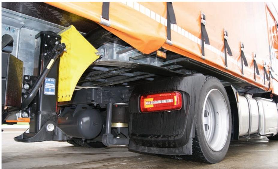
Bereich des Überhangradius zwischen Fahrgestellrahmen und Auflieger, was beim Rangieren an Laderampen und Befahren von Fähren von Bedeutung ist. An der Antriebsachse kommt die bekannte Dimension 315/45 R 22,5 Goodyear K-MAX D zum Einsatz. Als Aufpreis für die Tieferlegung des XF sind ein eher bescheidener Betrag von etwa 2.000 Euro im Gespräch.
