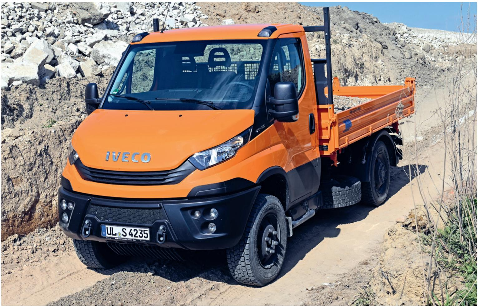
satzung. Fahrkomfort geht anders. Die parabelgefederte 5-t-Hinterachse und die 2,7-t-Vorderachse mit Einzelradaufhängung an Drehstabfedern vermögen es nicht, harte Stöße ausreichend zu absorbieren und geben sie ungefiltert an die bis zu drei Insassen weiter. Der 4x4-Daily mit seinem verwindungssteifen
