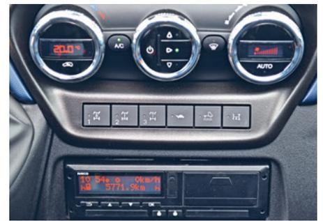
Die drei Differentialsperren sind nach der Reihenfolge ihrer Aktivierung auf den Tastschaltern durchnummeriert.
