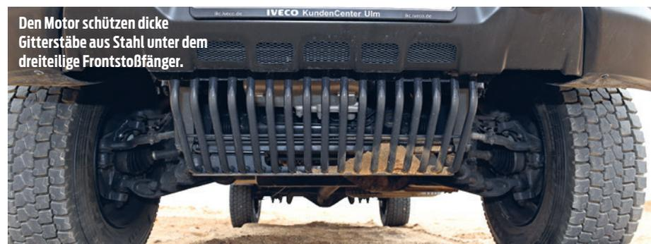
Den Motor schützen dicke Gitterstäbe aus Stahl unter dem dreiteiligen Frontstoßfänger.
