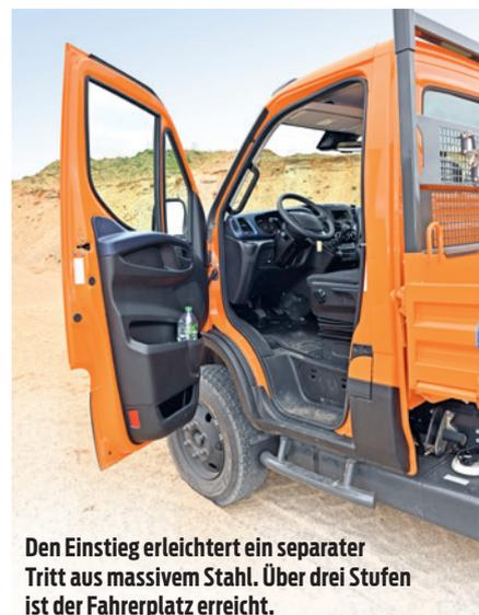
Den Einstieg erleichtert ein separater Tritt aus massivem Stahl. Über drei Stufen ist der Fahrerplatz erreicht.
