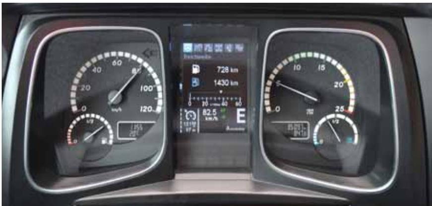
Jetzt spart er wieder: Immer wenn das „E“ im Display erscheint, ist PPC aktiv (im Bild oben Eco-Rollphase). Perfekte Voraussicht: von der optimalen Anfahrt und Schaltfolge bei steilen Anstiegen bis zum gezielten EcoRoll-Einsatz (unten)
