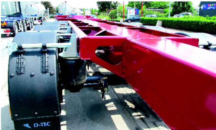
**Gewichtsoptimierung durch C-Längsträger und geschraubte Luftfeder-Aufnahmen**
