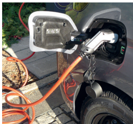
Die Batterien sind üppig bemessen, Strom wird vorne links getankt, Schnellladen klappt bis 100 kW.
