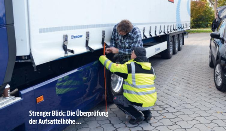
Strenger Blick: Die Überprüfung der Aufsattelhöhe ...
