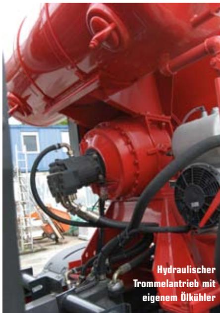
Hydraulischer Trommelantrieb mit eigenem Ölkühler
