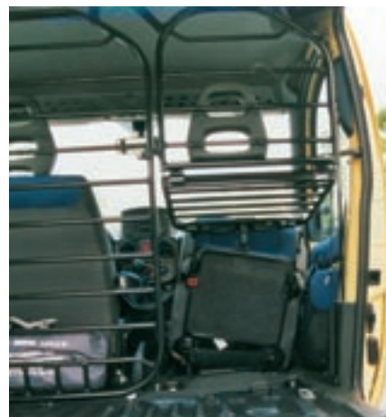
Kein Unfallschaden, sondern bei Fiat normal: der schiefe vorgeklappte Beifahrersitz, der im unteren Bereich die Ladelänge etwas verlängert
