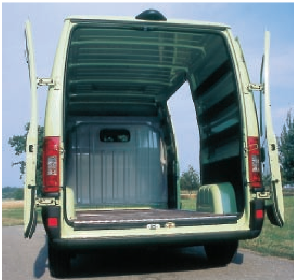
12 m 3 Laderaum wollen beim Großraum-Kastenwagen durch riesige Türen gefüllt werden. Beim Testwagen mit Komplett-Ausstattung immerhin gut 1,2 Tonnen Nutzlast.
