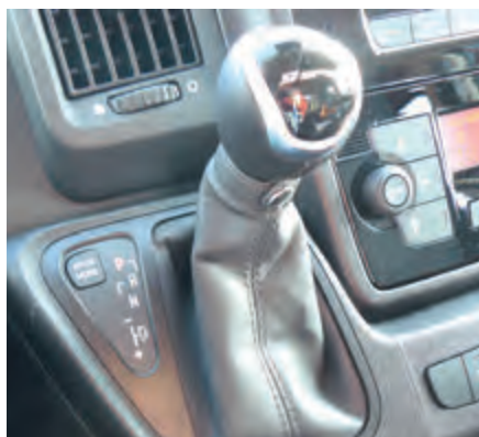
Wandlerautomatik mit neun Fahrstufen und drei Fahrprogrammen – die passende Variante findet sich immer.
