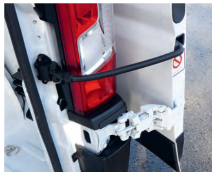
Die Heckflügelüren sind dank komplexer Scharniere frei von Aufstellern und öffnen auf Wunsch bis 270 Grad.
