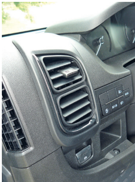
Auf der linken Seite steckt unter den neuen Lüftungsdüsen die Taste für die elektrische Feststellbremse.
