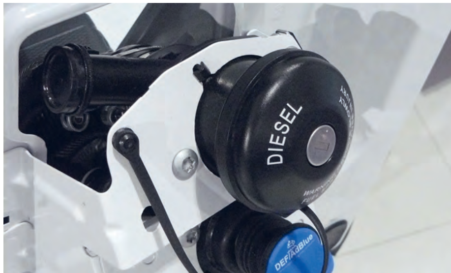
Auch die Nutzfahrzeugvarianten fahren jetzt mit SCR-Technik und Adblue.
